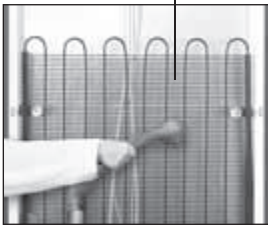
Рисунок 15 — Уборка холодильника (вид сзади)
